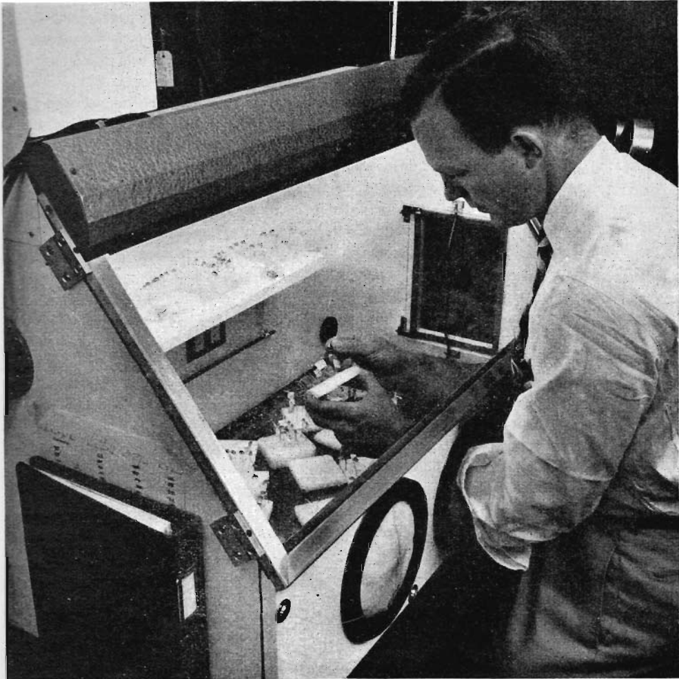
Fig. 1.2. - Una fase della preparazione di transistori. Sono necessarie estreme cautele per evitare che impurità si depositino sui cristalli di germanio. (Bell Telephone Laboratories).
