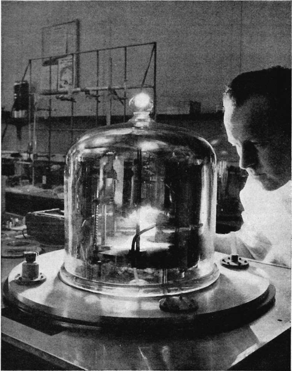
Fig. 1.10. - Una fase della preparazione dei transistori. Gli elettrodi di contatto sulle superfici di germanio sono ottenute vaporizzando un metallo su di esse. (Belle Telephone Laboratories).
